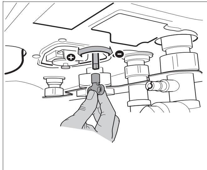
Рис. 28 Ограничитель расхода воды для теплой воды
