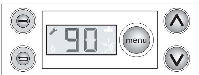
Рис. 20 DBA с гаечным ключом в режиме сервиса
